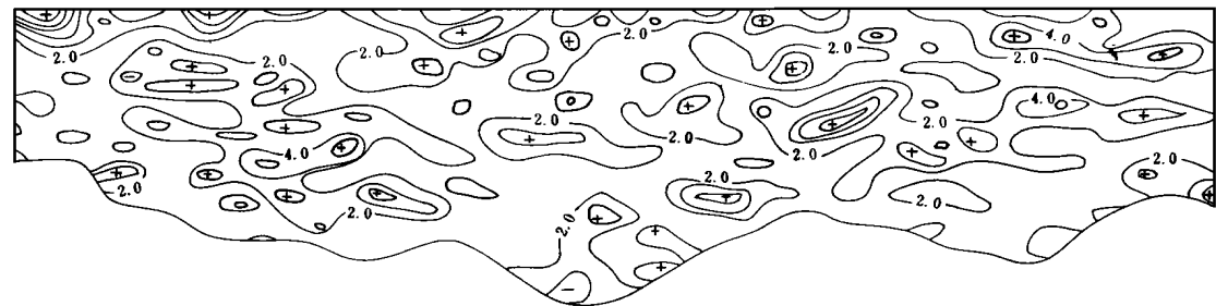
图 3 渗透率条件模拟剖面图
